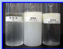
水 pH12.5 洗剤A (50倍) 従来の洗剤との比較テスト。同等の乳化(洗浄力)を發揮。
